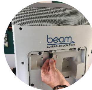
3. le branchement s'effectue via le port USB situé à l'arrière de la tête du robot.
