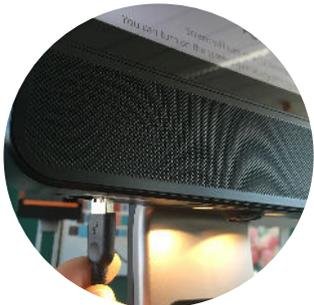
2. brancher la caméra externe via le port USB situé sous la tête du robot.
