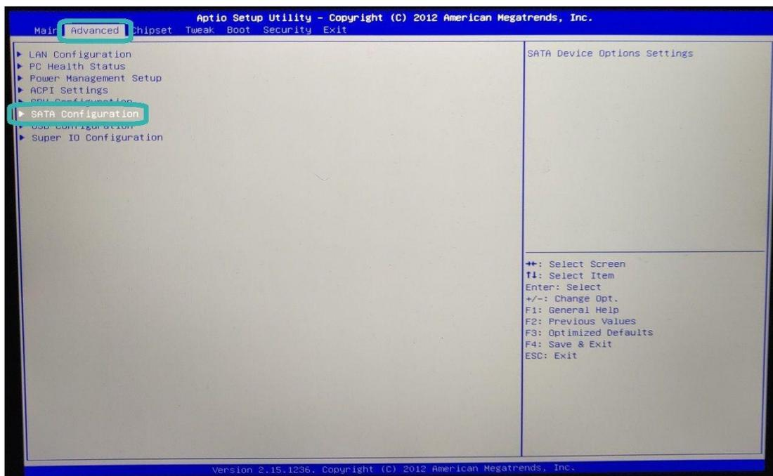
Dans le menu "SATA configuration", appuyer sur Enter pour ouvrir le menu de sélection "SATA mode". Sélectionner "Mode IDE" à la place de "Mode AHCI" et valider avec Entrée.
