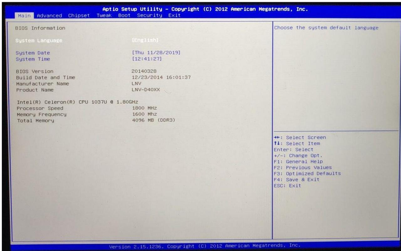
Aller dans l'onglet "Advanced" à l'aide des flèches puis sélectionner le menu "SATA configuration". Appuyez sur Enter pour valider.
