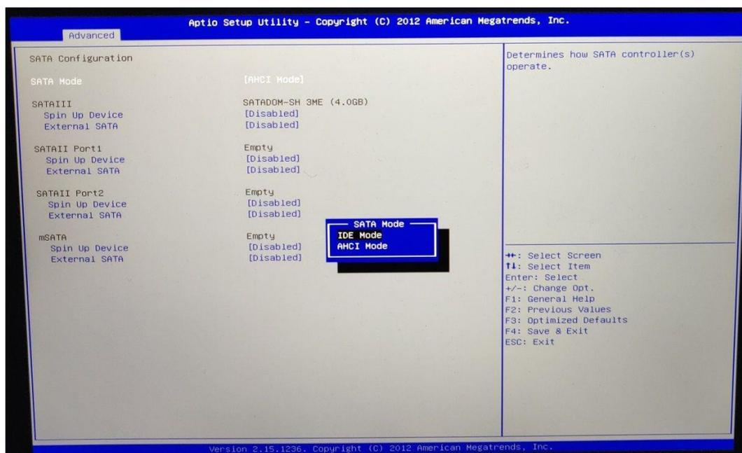
Appuyer sur le bouton Esc 1 fois et sur la flèche droite 3 fois pour arriver à l'onglet "Boot".
