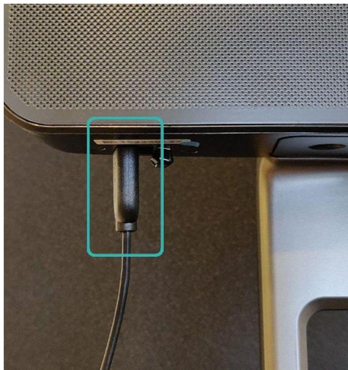
Brancher le clavier USB sur l'un des ports USB situés sous la tête du BEAM.
