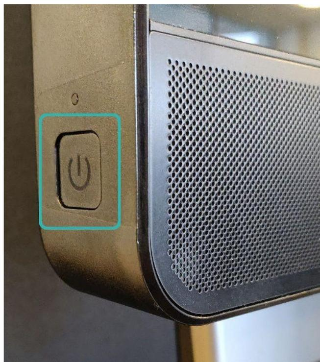
Éteindre le BEAM en appuyant sur le bouton situé sur le côté gauche de la tête.
